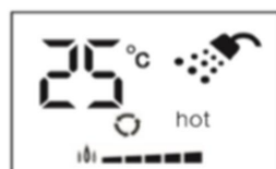
Работает горелка для горячей воды
